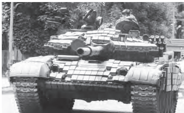
Танк Т-72А в 201-й мотострелковой дивизии. Душанбе, май 1992 года. Хорошо видно крепление контейнеров динамической защиты «Контакт-1» на корпусе, башне и бортовых экранах.
