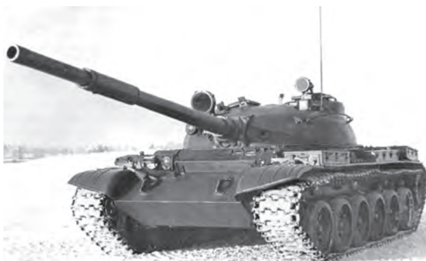
Опытный образец танка «объект 167» во время испытаний. Зима 1962 года. Конструкция ходовой части позже использовалась при проектировании танка «объект 172М».
