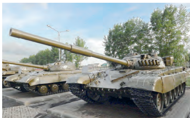
Танк Т-72А, общий вид машины. На борту башни — мортирки системы пуска дымовых гранат 902А «Туча-1».
