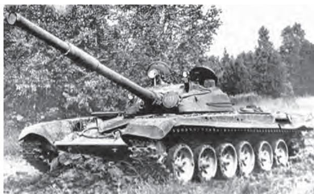
Испытания приспособления самоокапывания на танке «объект 172М». 1972 год.
